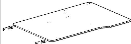
ENCAIXE AS CASTANHAS GIROFIX NAS RETAGUARDAS CONFORME O INDICADO
