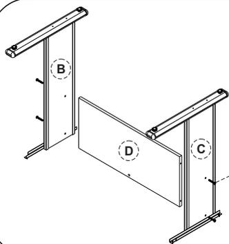
\* APÓS OS PÉS MONTADOS, FAÇA A FIXAÇÃO DA RETAGUARDA ATRAVES DOS PARAFUSOS ITEM 01.
