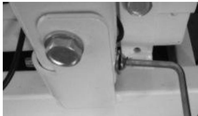
**3º Passo:** Coloque os dois Parafusos+Arruelas Arco (2) para fixar os guidões
