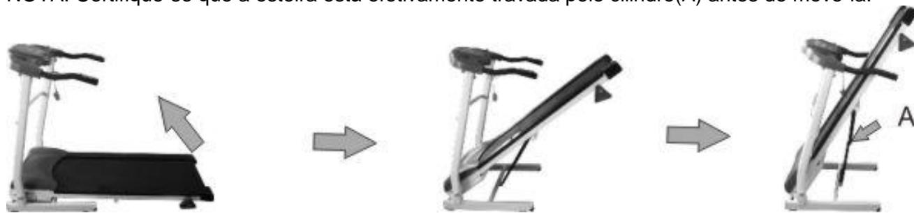
**Desdobrando:** Segurando na parte de trás da esteira com uma mão, use o pé para empurrar o cilindro (A) para destravar. Conforme a figura.
