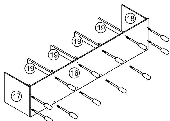
Fixe as peças 17,18 e 19 na peça 16 com cavilha 6,0 x 30 e parafuso 5,0 x 50.
