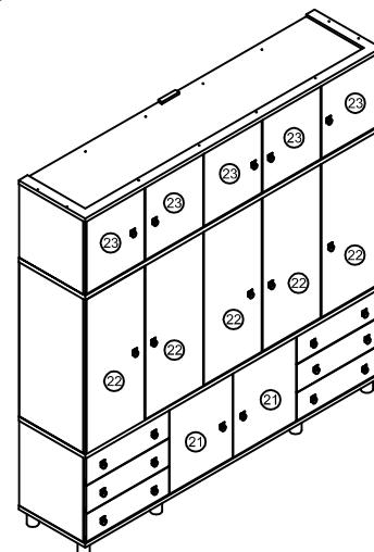
Fixe as portas 21,22 e 23 com Dobradiça e parafuso 4,0 x 14 Flangeado. Fixe os Puxadores com Parafuso 3 / 16 x 3 / 8.
