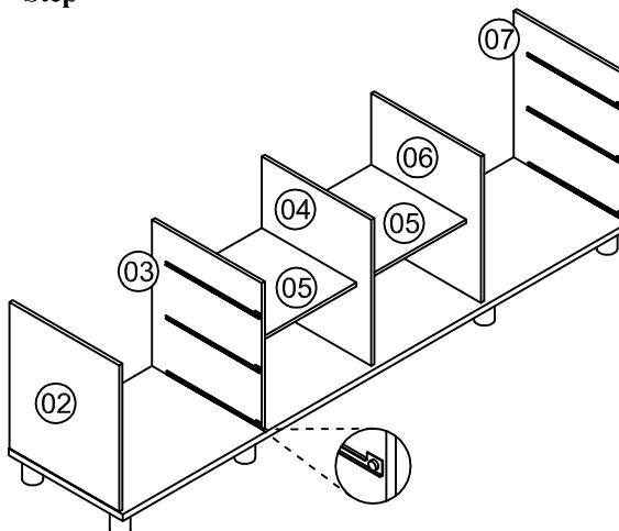
Fixe as peças 05 nas peças 03,04 e 06 com cavilha 6,0 x 30 e Mini-fix 15 x 12. Fixe as corrediças nas marquinhas das peças 02,03,06 e 07 com parafuso 3,5 x 12 Chato.
