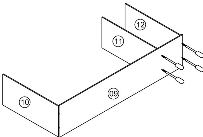
Fixe as peças 10,11 e 12 na peça 09 com cavilha 6,0 x 30 e parafuso 5,0 x 50 Chato.
