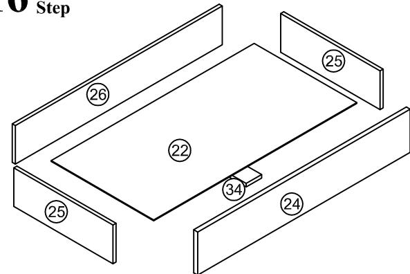
Fixe as peças 25 na peça 26 com cavilha 06 x 30 e mini-fix 12x12. Encaixe o fundo no canal das peças e fixe a peça 24 nas peças 14 com cavilha e mini-fix 12x11. Fixe a peças 34 na peça 26 com parafuso 3,5 x 30 e na peças 24 com cantoneira e parafudo 3,5 x 12 chato.
