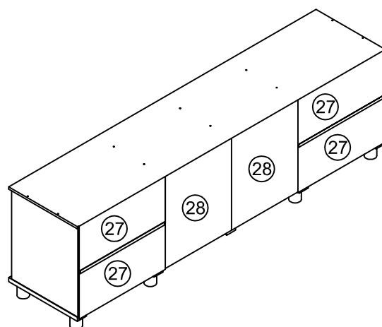
Coloque entre as peças 27 o Perfil H e fixe com prego 10 x 10.
