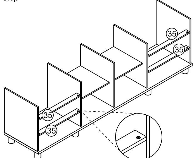
Fixe as peças 35 nas peças 02,03,06 e 07 com cavilha 06 x 30 e mini-fix 15 x 12.
