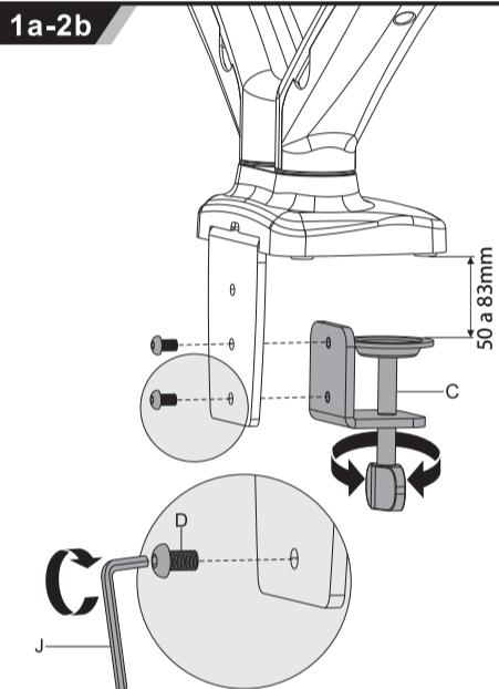
Identifique em quais furos da estrutura (B), a montagem atende melhor a instalação, de acordo com a espessura da mesa e fixe o conjunto, estrutura e manípulo (C), utilizando os parafusos (D).
