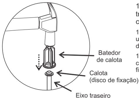
1 - Fixar uma calota em uma ponta do eixo traseiro usando o batedor de calota e batê-lo com um martelo conforme a figura ao lado.
