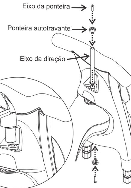
5 - Encaixar a direção nas ponteiras brancas da roda dianteira. Faça força em cima da direção contra o chão até ela encaixar totalmente nas ponteiras.
