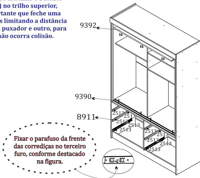
Fixar o parafuso da frente das corredeças no terceiro furo, conforme destacado na figura.
