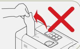
2. Se a alavanca for levantada durante o preparo de uma bebida, a luz indicadora multifunções pisca em VERMELHO, a distribuição é imediatamente interrompida e a máquina emitirá um sinal sonoro.
