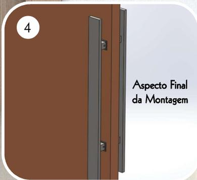
**!** A montagem para portas em vidro e madeira é a mesma, difere apenas no comprimento do parafuso M6. Por vezes faz-se necessário o corte do parafuso para um bom ajuste.
