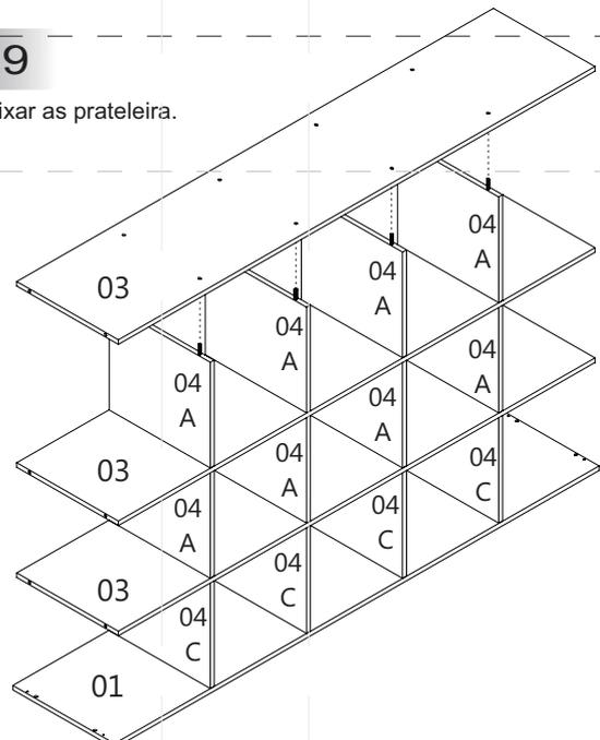
Colocar cola nos furos, após isso, encaixar as divisórias na prateleira, em seguida, colocar cola nas pontas.
