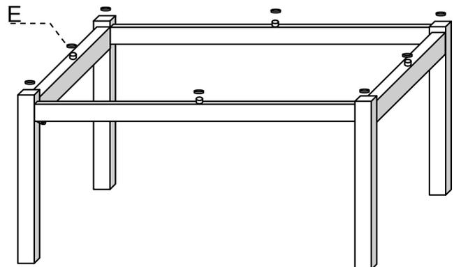
**4º PASSO:** CENTRALIZAR E ALINHAR O TAMPO E COLOCAR AS TAMPINHAS NOS PARAFUSOS.
