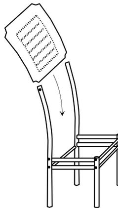
**3º PASSO:** ENCAIXE O TUBO DO ENCOSTO SUPERIOR E INFERIOR DENTRO DA ALMOFADA DO ENCOSTO E AJUSTE AS LATERAIS
