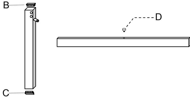
**2º PASSO:** COLOCAR TODAS AS TRAVESSAS E PARAFUSOS, DEIXANDO-AS SEM APERTO ATÉ A COLOCAÇÃO DO ÚLTIMO PARAFUSO.
