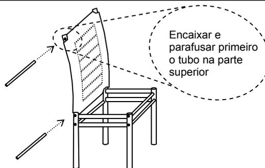
**4º PASSO:** VIRE A CADEIRA DE CABEÇA P/ BAIXO E PARAFUSE O ASSENTO USANDO A CHAPA CURVA P/ FIXAÇÃO
