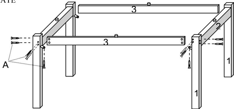
**3º PASSO:** REAPERTAR TODOS OS PARAFUSOS E COLOCAR O SILICONE NAS PONTEIRAS SUPERIORES DOS PÉS E DAS TRAVESSAS.
