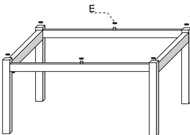
**4º PASSO:** CENTRALIZAR E ALINHAR O TAMPO E COLOCAR AS TAMPINHAS NOS PARAFUSOS.
