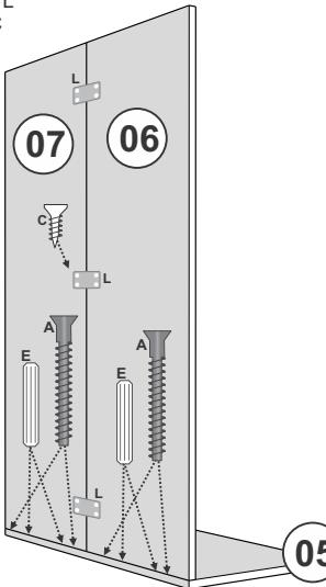
Fixar a peça 06 e 07 na peça 05 com Cavilha e Parafuso 4x50.
