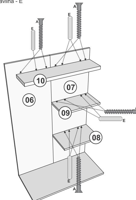
Fixar as peças 08 e 09 na peça 07 e a peça 10 nas peças 06 e 07 com Cavilha e Parafuso 5x40.
