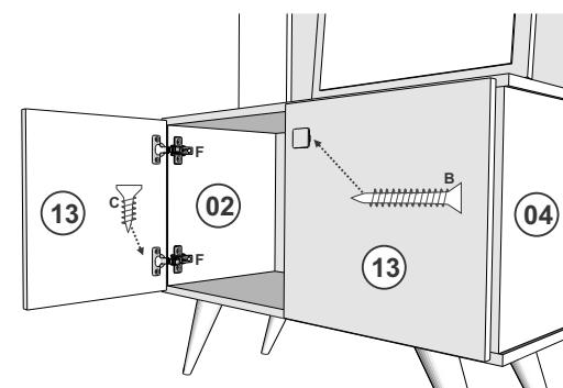
Fixar as portas 13 nas peças 02 e 04 com Dobradiça e Parafuso 3,5x12. Fixar os Puxadores com Parafuso 3,5x25.
