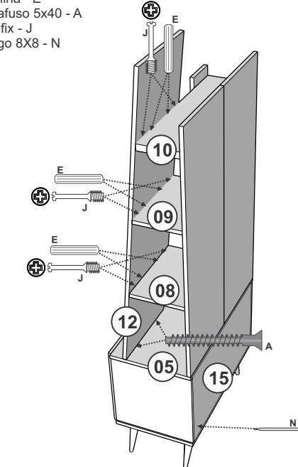
Fixar a peça 12 nas peças 08, 09 e 10 com Minifix e Cavilha e fixar na peça 05 com Parafuso 5x40. Fixar o fundo 15 com Prego.
