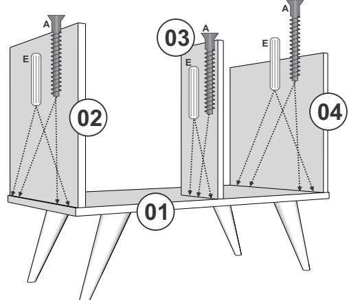
Fixar as peças 02, 03 e 04 na peça 01 com Parafuso 5x40 e Cavilha.
