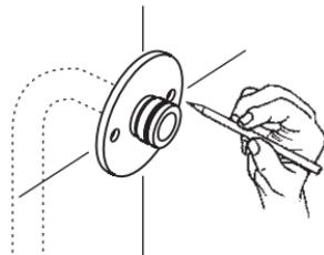
Retire a flange e a conexão e fure nos locais marcados. Coloque as buchas.
