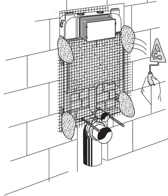
9 Após aplicar o cimento uniformemente e com o mesmo já seco, aplique o revestimento.
