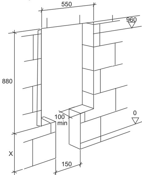
6 A caixa de descarga deve ser nivelada conforme exemplo:
