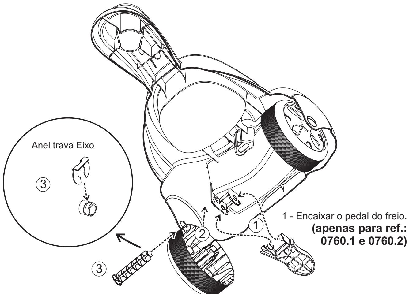
3 - Passar o eixo de fora para dentro, pelo corpo e a roda do triciclo e travar o conjunto com o Anel Trava Eixo na fenda do eixo.
