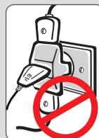
O uso incorreto do plugue com pino de aterramento pode resultar em risco de choque elétrico. Se o cabo de alimentação estiver danificado, entre em contato com o Serviço Autorizado Electrolux para que seja feita a substituição.
