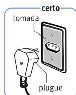
O cabo de alimentação deve ser conectado a uma tomada aterrada exclusiva. Não retire, sob quaisquer circunstâncias, o pino de aterramento do cabo de alimentação. Se você tiver qualquer dúvida sobre o aterramento na sua residência, entre em contato com um eletricista qualificado.
