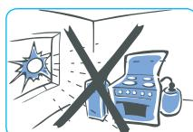
Os raios solares podem afetar o acabamento do aparelho e as superfícies aquecidas podem causar o aumento do consumo de energia elétrica. Ambientes com temperaturas muito baixas também podem afetar a performance do produto.
