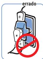
Nunca desligue a Adega da tomada puxando pelo cabo de alimentação. Use o plugue. Sempre encaixe bem o plugue na tomada.
