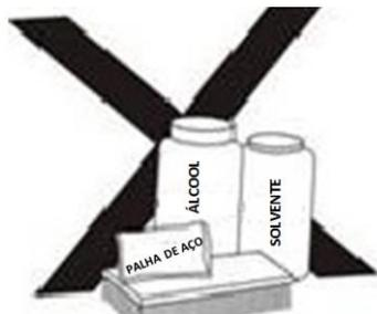
**Importante:** Não esguiche água no produto para que não molhe a parte elétrica ou mecânica do refrigerador, bem como não utilize produtos químicos ou abrasivos, tais como: álcool, querosene, solventes, para efetuar a limpeza.
