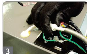
**4º** Usando uma chave Phillips, retire o parafuso que fixa o fio de aterramento localizado na dobradiça superior esquerda.
