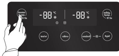
Cada toque na tecla TFreezer Temp. altera a temperatura conforme a sequência abaixo:
