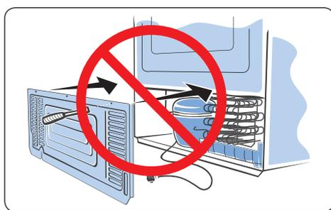
Seu refrigerador possui um coletor de água e um condensador localizado na parte traseira próximo ao compressor (motor). A função do coletor é armazenar água do degelo automático, que depois evapora através do calor gerado nesta região. A função do condensador é auxiliar na refrigeração.
