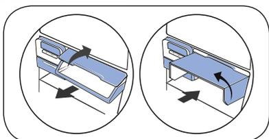
2. Retirar a tampa e a prateleira do compartimento turbo congelamento, e após isto, desencaixar o *Ice Twister*, conforme figura.
