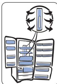
Este sistema tem a função de distribuir o ar frio para o resfriamento dos alimentos no compartimento freezer e refrigerador.
