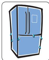
Os refrigeradores, freezers e combinados de uso doméstico quando instalados em locais com umidade relativa do ar acima de 75% e com temperaturas superiores a 32°C podem apresentar condensação externa (suor).
