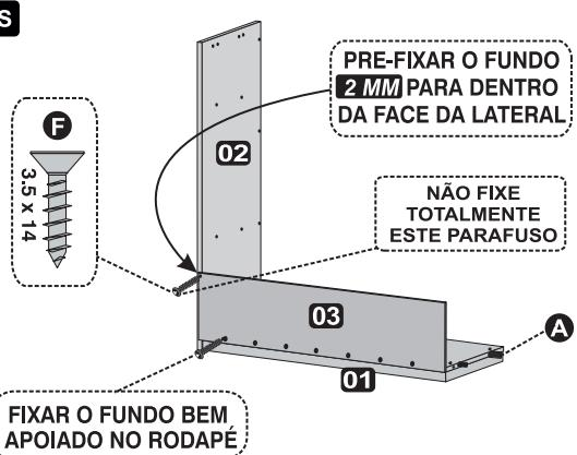
**03** Usando um perfil H como medida fixar a divisão, em seguida pré-fixar no fundo para que ela não caia.
