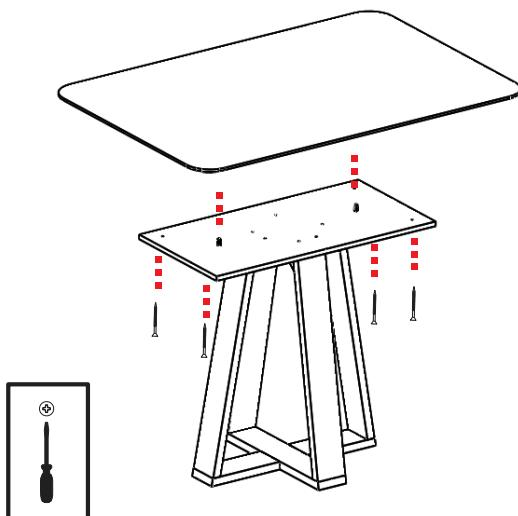
**4** Parafusar contra-tampo (3), no tampo (4), utilizando o parafuso (B), conforme imagem abaixo.
