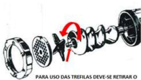
PARA USO DAS TREFILAS DEVE-SE RETIRAR O DISCO E A LAMINA. O PARAFUSO INDICADO DEVE SER DESROSCADO NO SENTIDO ANTI-HORÁRIO, E COLOCADO O PARAFUSO CABEÇA FENDA.
