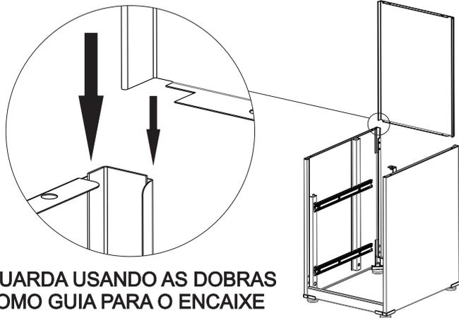
ENCAIXE A RETAGUARDA USANDO AS DOBRAS DAS LATERAIS COMO GUIA PARA O ENCAIXE
