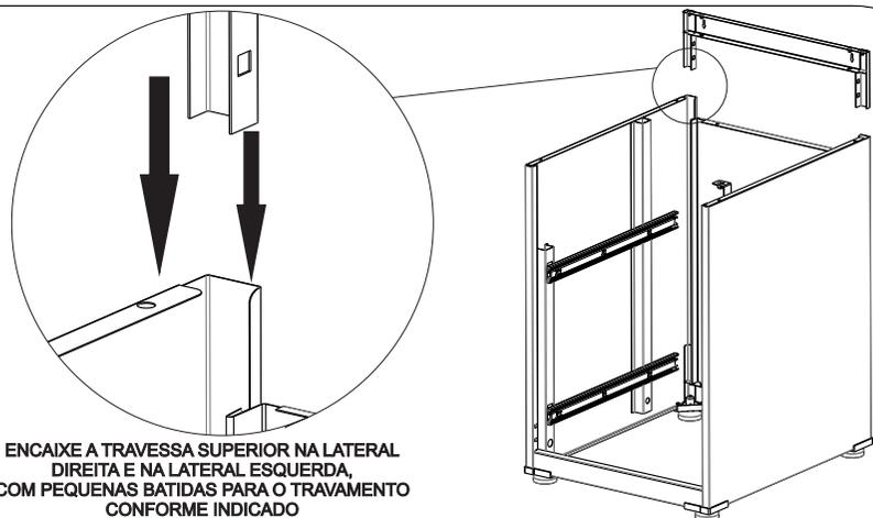
ENCAIXE A TRAVESSA SUPERIOR NA LATERAL DIREITA E NA LATERAL ESQUERDA, COM PEQUENAS BATIDAS PARA O TRAVAMENTO CONFORME INDICADO
