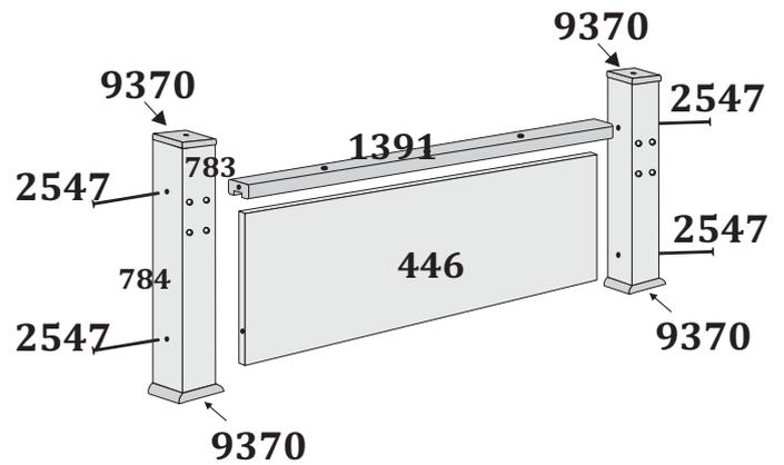
**2** Utilize os parafusos (2559/2549/2547) para fixar as réguas (223/228) nos pés cabeceira e peseira. Coloque os tubos (20887) com as ponteiros (20888/20889) antes de travar as réguas (223/228) nos pés.
