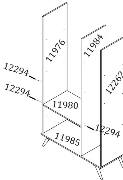
**4** Fixe as prateleiras (11987) na lateral (12262) e na divisão (11984) utilizando o parafuso (12294). Em seguida, fixe a prateleira (11980) na lateral (11976) e na divisão (11984) utilizando o parafuso (12294).
