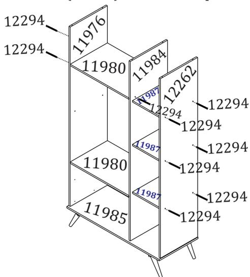
**5** Fixe o tampo (11986) nas laterais (12262/11976) e na divisão (11984) utilizando o parafuso (12294).
