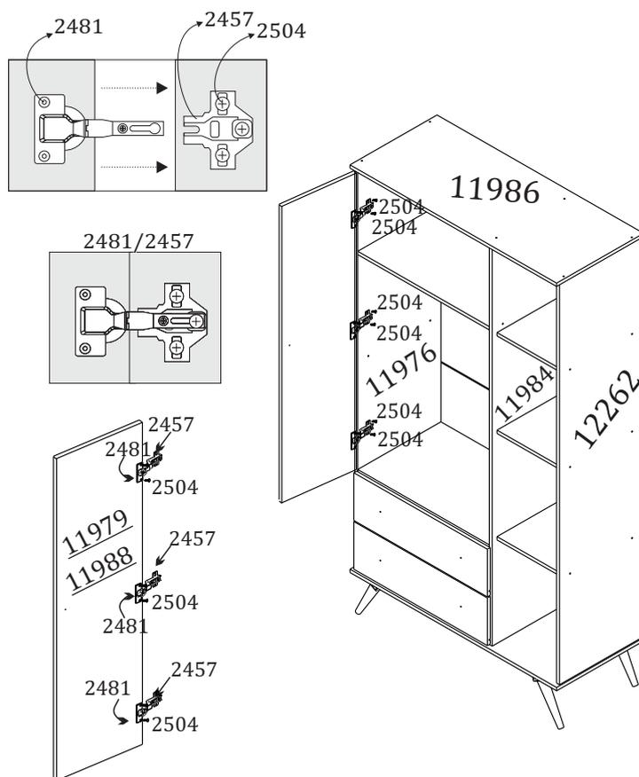
**10** Fixe as gavetas e as portas (11979/11988) e em seguida, coloque os puxadores (12021) utilizando o parafuso (2520).
