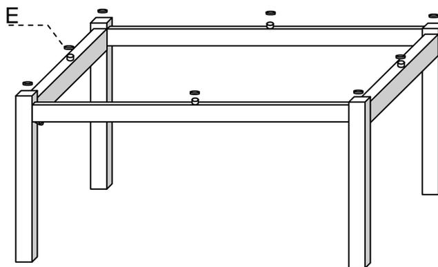
**4º PASSO:** CENTRALIZAR E ALINHAR O TAMPO E COLOCAR AS TAMPINHAS NOS PARAFUSOS.
