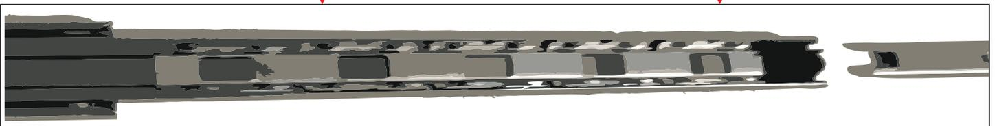
\*\*\* Se a corredeira estiver pesada de forma anormal, verifique se está encaixada corretamente nas canaletas, retire-a e torne a encaixar verificando novamente.
