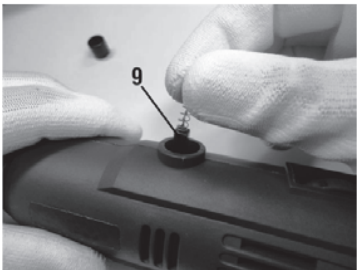
Fig. 6 – Sustitución de cepillo carbón
