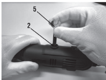
Fig. 6 – Substituição da escova de carvão
