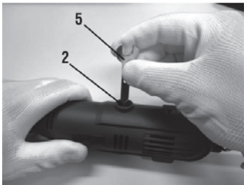
Fig. 6 – Sustitución de cepillo carbón
