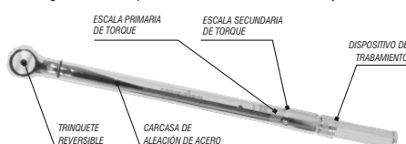
Figura 4 – Componentes de los modelos con encaje 3/4"
