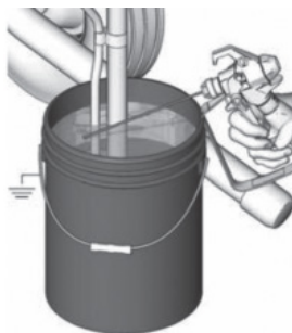
Figura 11 - Acionando a máquina para liberar pressão
