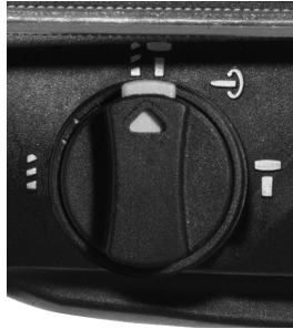
Fig. 5 – Posição para perfuração com impacto
