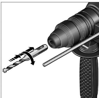
Fig. 2 – Desenho demonstrativo para instalação do acessório
