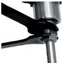
Fig. 3 - Montaje de la pala en herramienta
