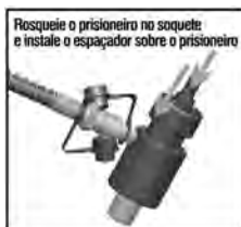
Fig.4 – Instalação do prisioneiro e espaçador
