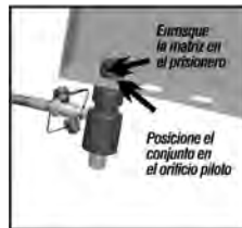
Fig.5 – Montaje del conjunto en la chapa
