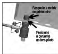
Fig.5 – Montagem do conjunto na chapa
