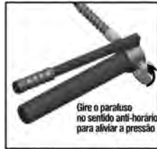
Fig.8 – Alívio de pressão da bomba
