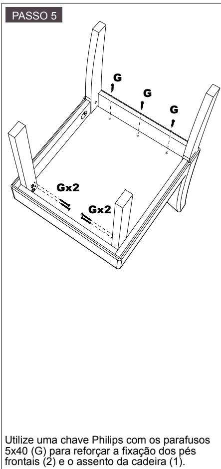
Utilize uma chave Philips com os parafusos 5x40 (G) para reforçar a fixação dos pés frontais (2) e o assento da cadeira (1).
