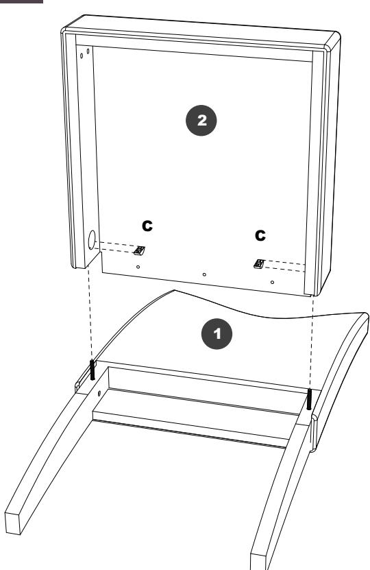
Coloque as arruelas meia-lua (C) no assento (2). Depois encaixe o assento (2) no encosto (1) utilizando as barras roscadas (B) fixadas anteriormente.
