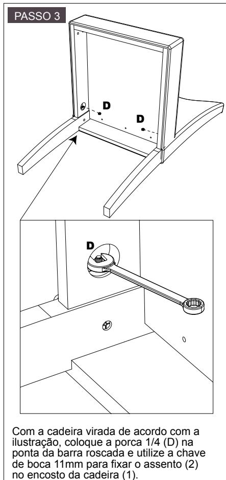
Com a cadeira virada de acordo com a ilustração, coloque a porca 1/4 (D) na ponta da barra rosada e utilize a chave de boca 11mm para fixar o assento (2) no encosto da cadeira (1).
