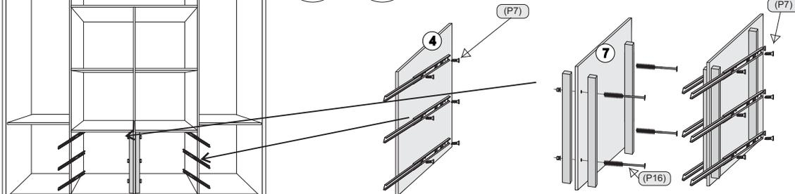
MONTAR O TRILHO INFERIOR (23) NA BASE COM PARAFUSO 3,5 X 14 (P1)
