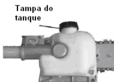
2. Remova a tampa do reservatório e complete-o com óleo de corrente para motosserras e coloque a tampa.
