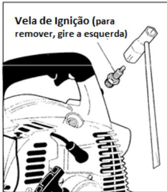
1 Use a chave de velas para remover a vela de ignição (sentido anti-horário para remover).
