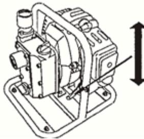
1. Quando o motor estiver quente o suficiente para trabalhar, ajuste o acelerador para a rotação desejada.
