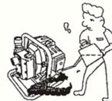
DESLIGUE O MOTOR! NÃO DERRAME COMBUSTÍVEL!
