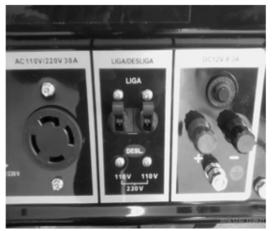
Quando o disjuntor desligar durante a operação, significa que o gerador está sobrecarregado ou existe algum problema com a utilização. Desligue o gerador imediatamente, verifique qual o problema na utilização ou qual defeito está sobrecarregando o gerador e repare se necessário.
