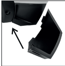
Figura 8 – Encaje del soporte para lanza
