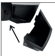
Figura 8 – Encaixe do suporte para lança
