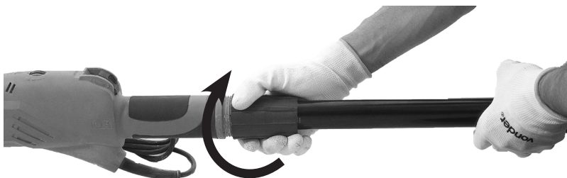
Figura 10 – Travando o sistema
