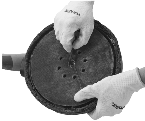
Figura 13 – Extração e instalação da base do disco
