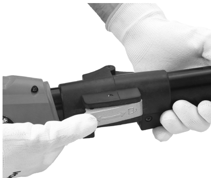
Figura 3 – Travando o cabo
