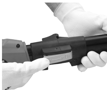
Figura 3 – Trabando el cable
