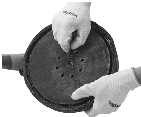
Figura 13 – Extracción e instalación de la base del disco
