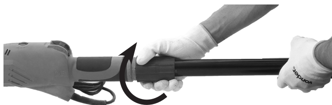
Figura 10 – Travando o sistema
