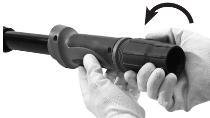
Figura 8 – Abertura del cable
