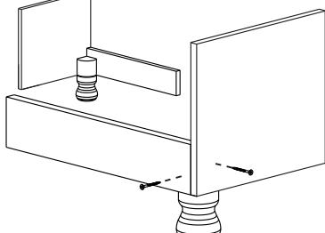
**Atenção:** O Pé de Plástico deverá ser fixado do Pé para a Lateral/Rodapé (de dentro para fora), com parafusos 3,5x12 como mostra a ilustração acima.
