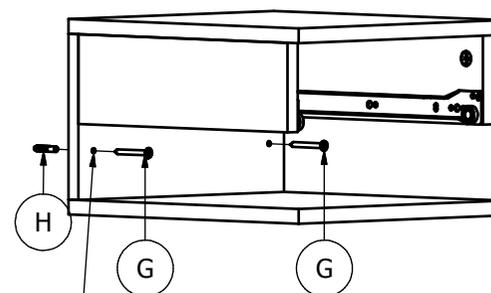
Utilizar furos p/ fazer a marcação na parede.
