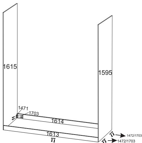
**2** Fixar base 1594 na lateral 1595, sobre rodapés 1613 e 1614 com parafusos 1702.
