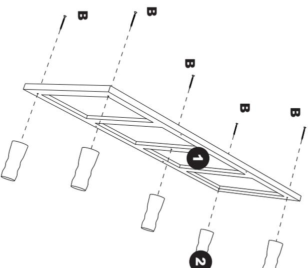
Fixe os pés do móvel (2) na base do balcão (1) utilizando os parafusos maiores (B)
