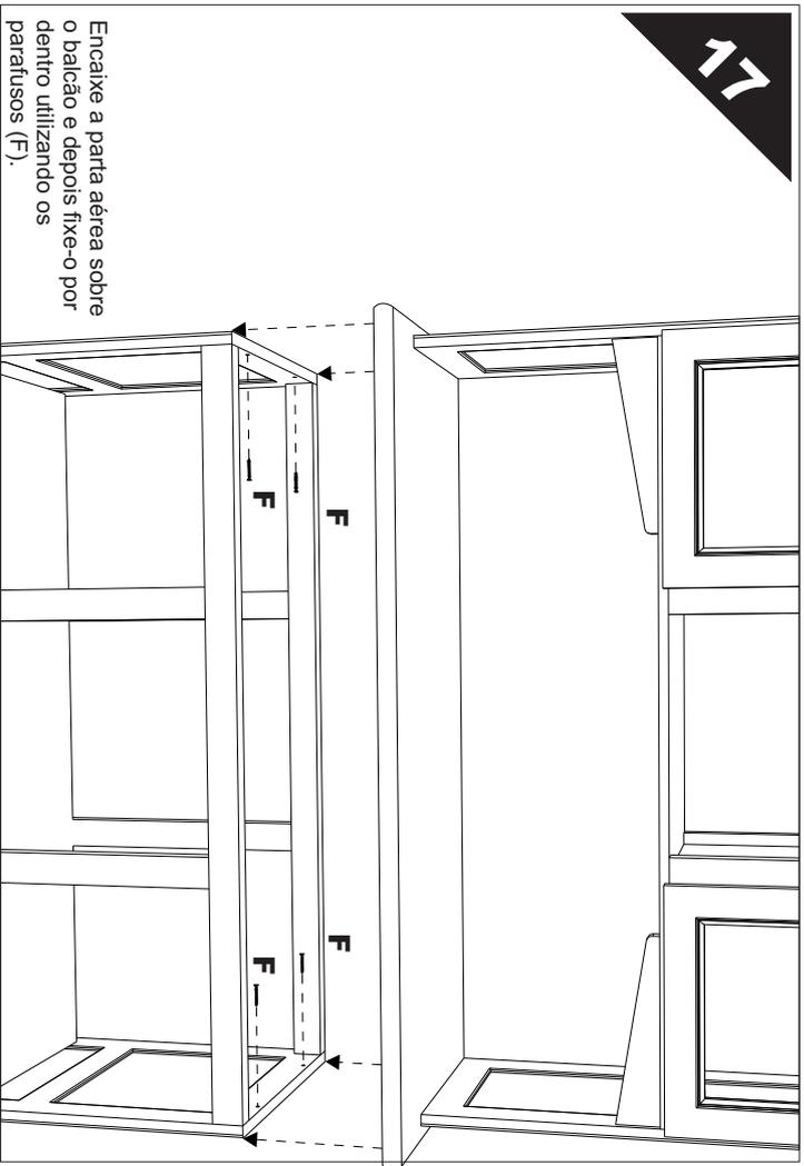
Encaixe a porta aérea sobre o balcão e depois fixe-o por dentro utilizando os parafusos (F).
