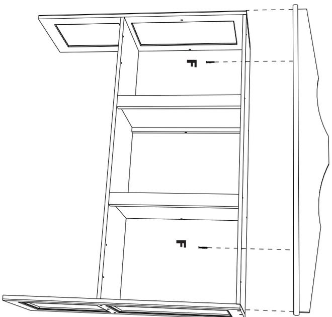
Fixe a moldura montada anteriormente utilizando os parafusos (F) conforme demonstra a ilustração.
