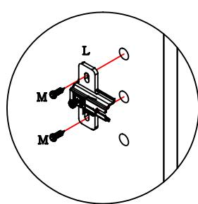
A dobradiça "K" deve ser encaixada no calço "L" e estes colocados com os parafusos "M", observando o procedimento a cima.
