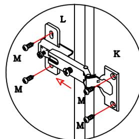
A dobradiça "K" deve ser encaixada no calço "L" e estes colocados com os parafusos "M", observando o procedimento a cima.
